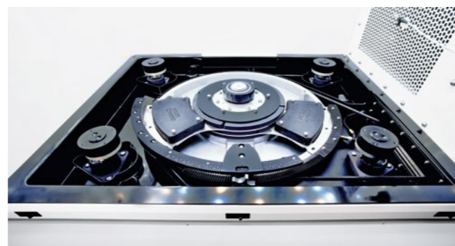
Eppendorf X-Drive mit fünf exzentrischen Anlenkungen und justierbarer Auswuchtung sorgt für einen verlässlichen Betrieb
