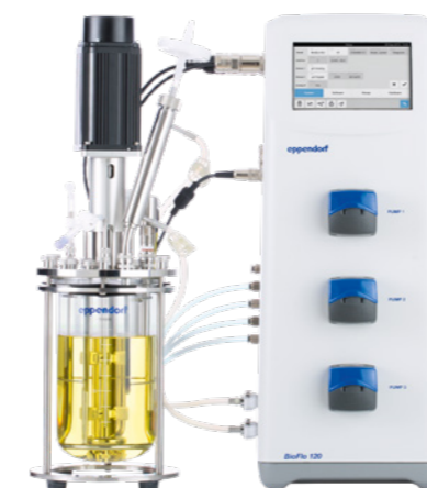
BioFlo® 120 0,4 – 10,5 L Arbeitsvolumen (autoklavierbar), 0,25 – 40 L Arbeitsvolumen (Einweg)
