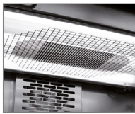
Lichtkassetten mit drei Lichtqualitäten wählbar: Tageslicht, Arabidopsis, FLUORA
