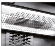
Lichtkassetten mit drei Lichtqualitäten wählbar: Tageslicht, Arabidopsis, FLUORA
