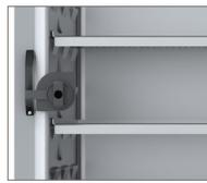
DuoDoor™ : ouverture simultanée des portes intérieure et extérieure
