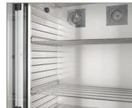
Conditions climatiques homogènes grâce à la technologie de chambre de pré-chauffage APT.line™
