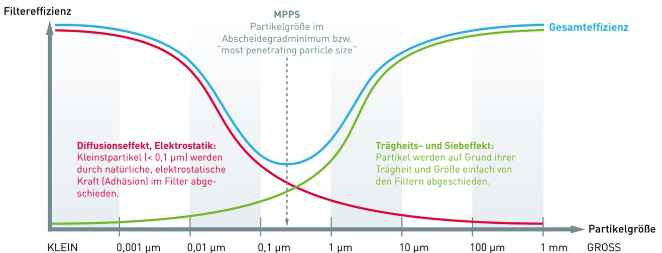
**i** Die kritischsten Partikel liegen bei einem Durchmesser von ca. 0,3 µm und sind am schwierigsten zurückzuhalten (Fachbegriff MPPS = Most Penetrating Particle Size). Die MPPS bilden die Grundlage für die Definition der Effizienz von Partikelfiltern.
