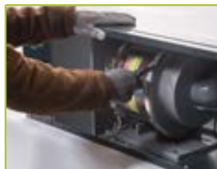
3 Monter le filtre à charbon actif, le fixer et fermer la face avant du boîtier
