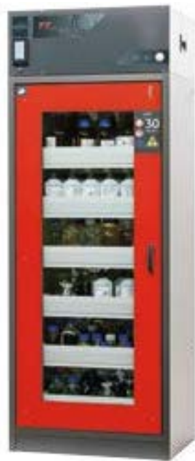
Armoire ventilée filtration intégrée modèle FX30.229.086.WDFW corps gris anthracite (RAL 7016), avec porte battante en rouge signalisation (RAL 3020), équipée avec 6x tiroir (tôle d'acier revêtement époxy), 1x bac de rétention au sol (tôle d'acier revêtement époxy) Code article 32946-066-33629 (l'illustration intègre la plinth en option)
